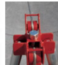
Particolare dell'innesto della fune metallica attraverso i rulli del palo integrato a traliccio
