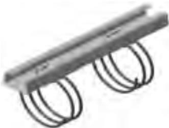
Estribado con espiral transversal al perfil (estribo perfilado para ensartar).
