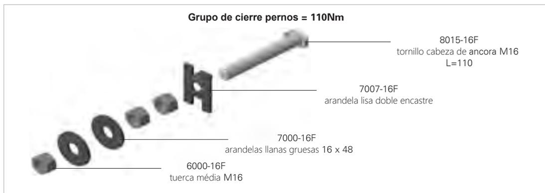
La elección de la longitud del tornillo cabeza anclora varía en función de la distancia que hay entre el panel y el perfil de anclaje en la estructura (para la longitud disponible véase pág. 58)
