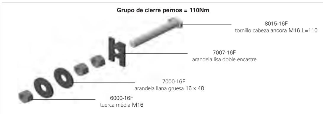
La elección de la longitud del tornillo cabeza ancora varía en función de la distancia que hay entre el panel y el perfil de anclaje en la estructura (para la longitud disponible véase pág. 52)
