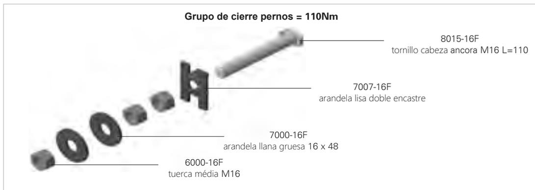
La elección de la longitud del tornillo cabeza anclora varía en función de la distancia que hay entre el panel y el perfil de anclaje en la estructura (para las longitudes disponibles véase pág. 58)
