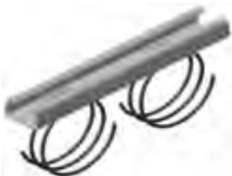
Estribado con espiral longitudinal al perfil especial para anclaje en ramal
