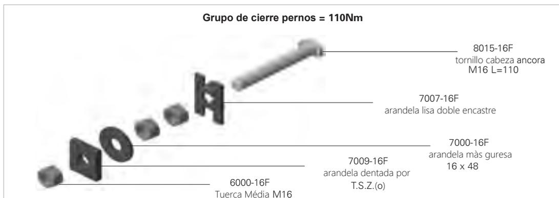
La elección de la longitud del tornillo cabeza ancora varia en función de la distancia que hay entre el panel y el perfil de anclaje en la estructura (para la longitud disponible véase pàg. 52)
