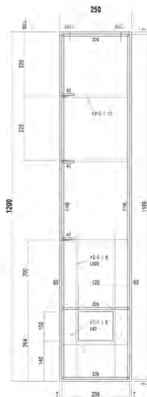
Pannelli verticali > 10 m con finestra
