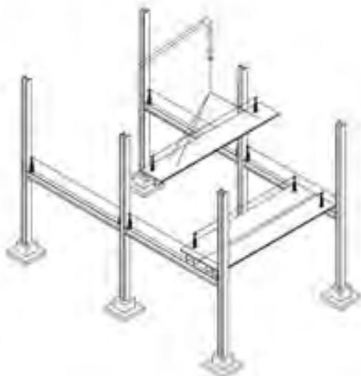
Terminato il piano si lascia la linea perimetrale, il piano è in sicurezza e si procede alla costruzione del piano successivo.
